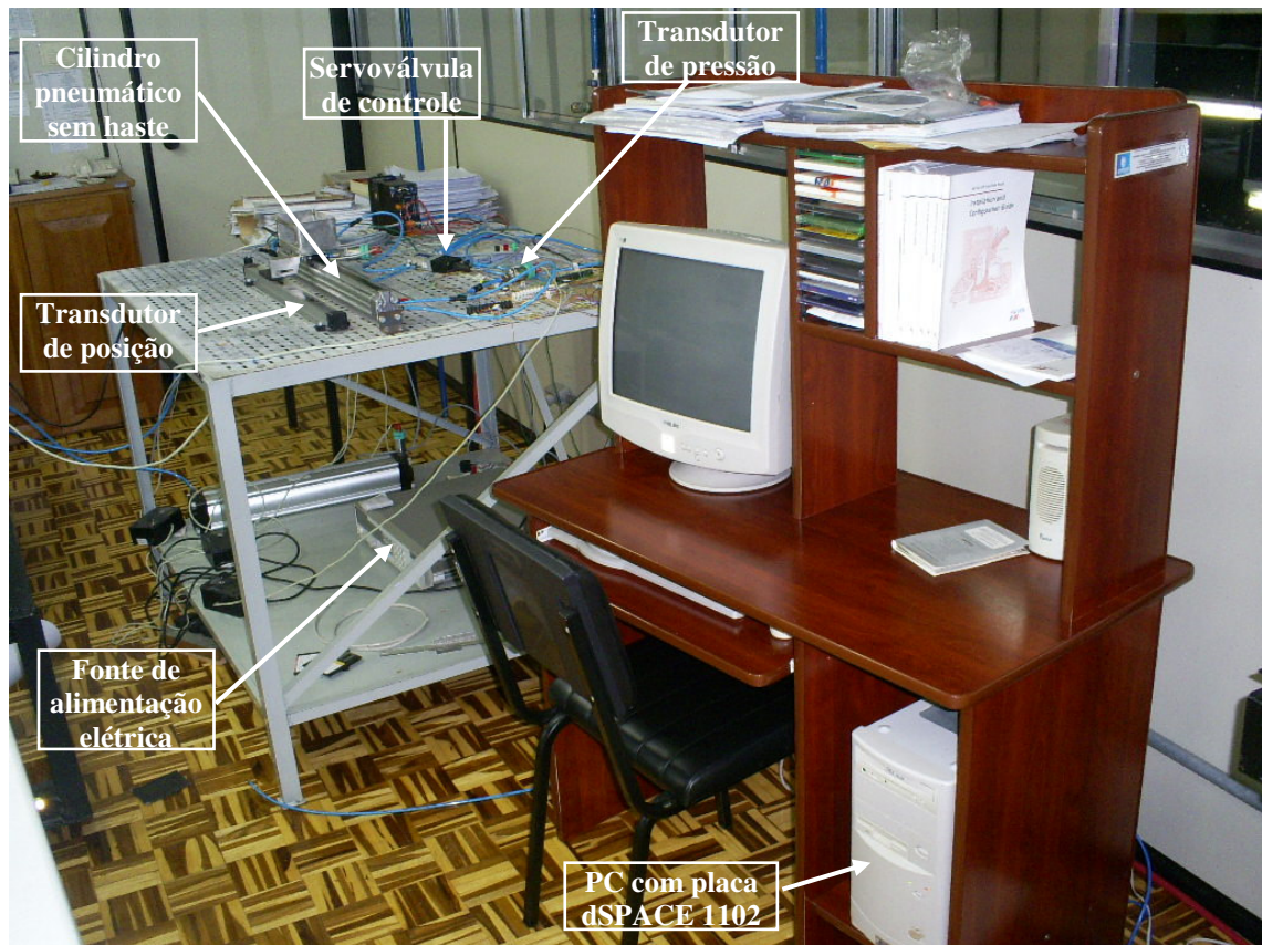
Figura 3: Bancada de testes do laboratório de automação do Campus Panambi da Unijuí
