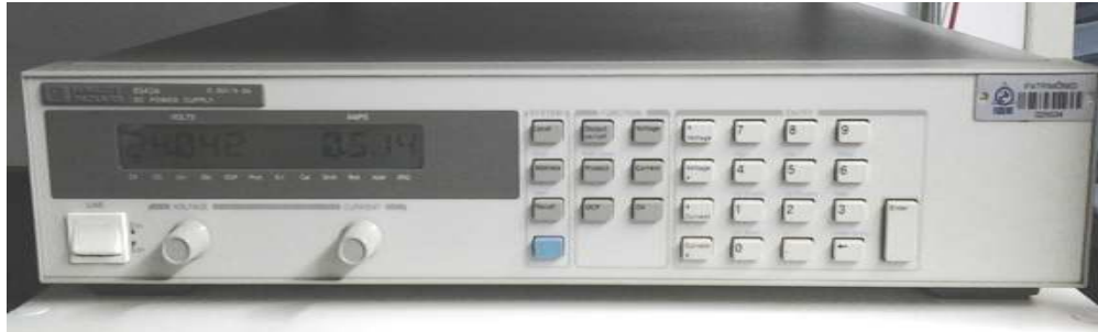
Figura 3.3 – Fonte HP para alimentação da servoválvula proporcional direcional com 24VDC.
